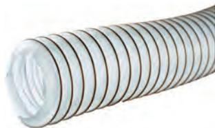
Flexible très souple et léger. Convient au transport de matériaux abrasifs, tels que les copeaux de bois, la sciure, la poussière de ciment, les granules et les gaz techniques des industries chimiques et pétrochimiques. Très bonne résistance à l'usure et au vieillissement. Bonne résistance aux carburants, huiles, solvants et graisse.
